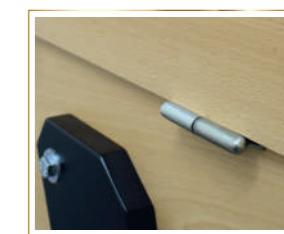
Caisse ouvrante facilitant le nettoyage du tapis
